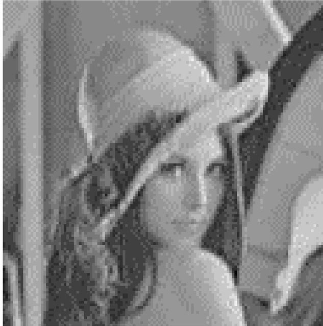
Figura 6.14: Imagem da Figura 6.12 comprimida através do GHAPCA, considerando  $k = 16$  ( $k < m$ ) neurônios na camada de saída da RNA. O coeficiente de compressão resultante é  $\rho = 0.316406$ . A fidelidade da imagem comprimida com relação à original é dada por  $\text{PSNR} = 31.4$  dB.
