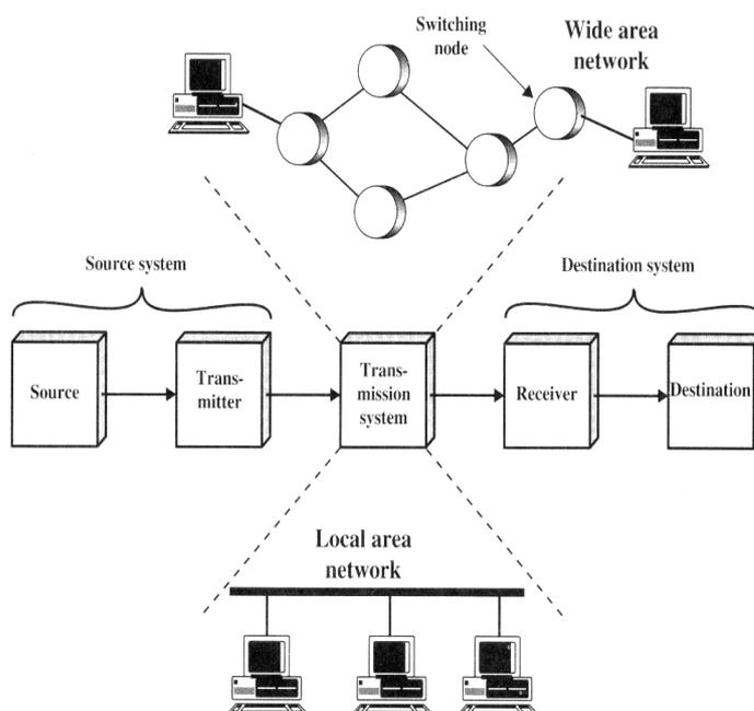
Na figura ao lado, os *links* entre dois nós de comutação (*switching nodes*) são *links* ponto-a-ponto, enquanto que o *link* que conecta as estações presentes na LAN é um *link* multiponto.
