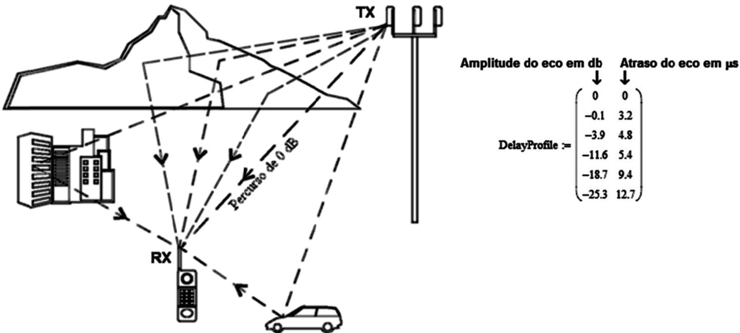
Sabendo que a modulação do transmissor (TX) digital é *M*-QAM, que a frequência central do canal é  $f_0=2400\text{MHz}$  e que o *symbol rate* do TX é 10 MHz, pede-se:
