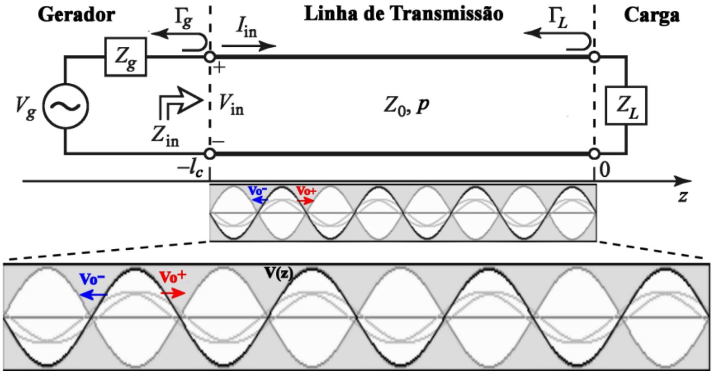
**Figura A.1:** Antena representada pela impedância  $Z_L = Z_A$ , sendo  $Z_A$  a impedância “vista” nos terminais da antena (= impedância de entrada da antena). A impedância de carga  $Z_L$  (a antena) situa-se na coordenada  $z=0$  do eixo  $z$  e é alimentada pela linha de transmissão de comprimento  $l_c$ , impedância característica  $Z_0$  e fator de velocidade  $p$ . Assume-se que a linha de transmissão é sem perdas, isto é, a potência útil é conservada ao longo da linha de transmissão.
