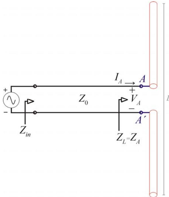
**Figura 14:** Antena Dipolo alimentada por uma linha de transmissão (cabo coaxial) de impedância característica  $Z_0$ . A impedância de carga  $Z_L$  da linha de transmissão é a impedância  $Z_A$  "vista" nos terminais  $A$  e  $A'$  da antena. **Nota:** O Apêndice A ao final deste capítulo resume as equações da teoria de linhas de transmissão para efeito de determinação das tensões, correntes e potências envolvidas na alimentação de uma antena através de um cabo coaxial.
