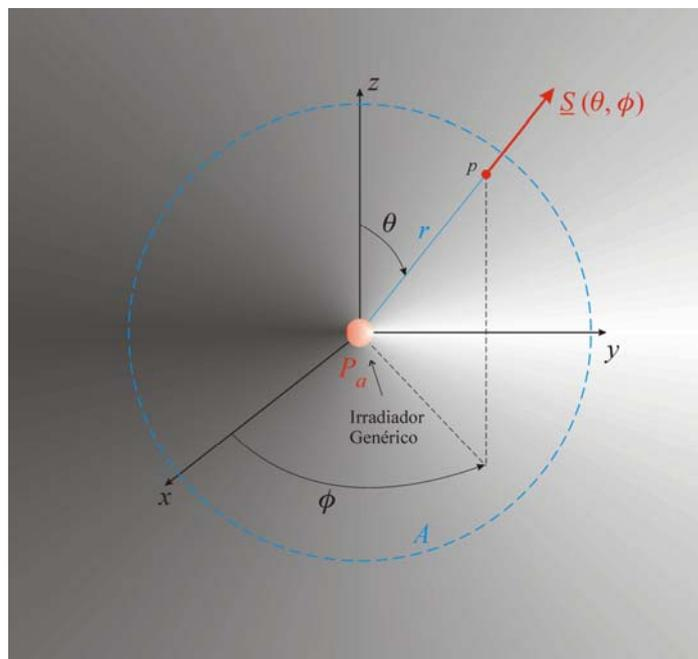
**Figura 10:** Irradiador não isotrópico sem perdas, alimentado por uma potência  $P_a$ , e o conseqüente Vetor de Poynting Médio  $\underline{S}(\theta, \phi) \left[ \frac{\text{W}}{\text{m}^2} \right]$  resultante em um ponto  $p$  do espaço  $\mathfrak{R}^3$ .
