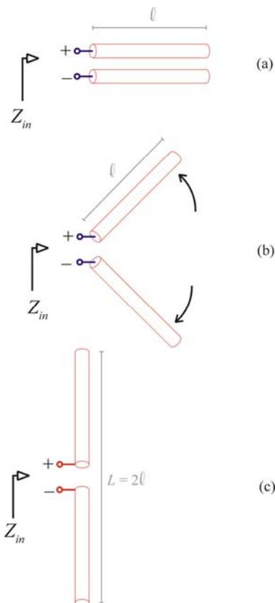
**Figura 15:** Transformações geométricas aplicadas sucessivamente em uma linha de transmissão de comprimento  $\ell$  com os terminais de saída abertos de modo a formar um dipolo simétrico de comprimento  $L = 2\ell$ .
