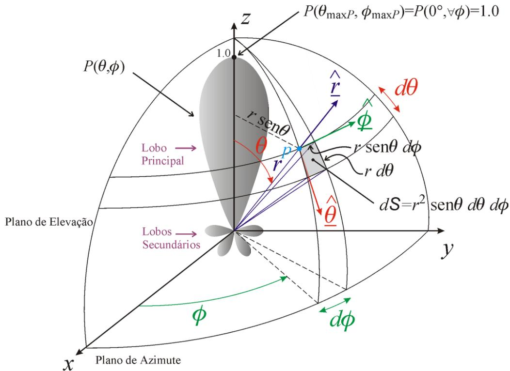
**Figura 11:** Padrão de Potência  $P(\theta, \phi)$  típico de um irradiador de alta Diretividade (conceito a ser definido logo a seguir). Observe a existência de lobos secundários além do lobo principal alinhado com o eixo  $z$ .
