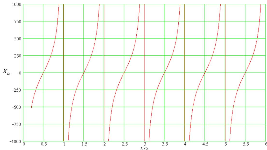
**Figura 16:** Gráfico de  $X_A = \operatorname{Im}\{Z_{in}\} = X_{in}$  em função de  $L = 2\ell$ .
