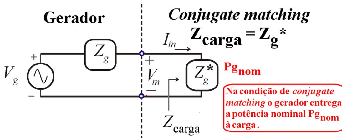
Portanto, operando na condição de *conjugate matching*, a tensão resultante nos terminais da carga fictícia  $Z_{carga}$  é dada por  $V_{in} = \sqrt{P_{g_{nom}} \cdot Z_{carga}} = \sqrt{1\text{KW} \cdot 52\Omega} = 228.03 \text{ Vrms}$ . Como, nesta condição,  $Z_{carga} = Z_g^* = Z_g = 52\Omega$ , então do divisor de tensão formado por  $Z_g$  e  $Z_{carga}$  obtemos a tensão  $V_g$ :
