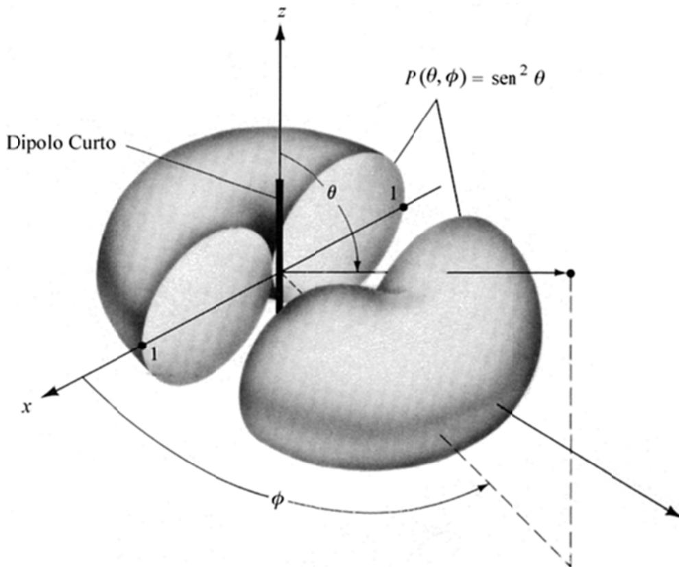
**Figura 6:** Gráfico de  $P(\theta, \phi) = |F(\theta, \phi)|^2$  para o dipolo curto.
