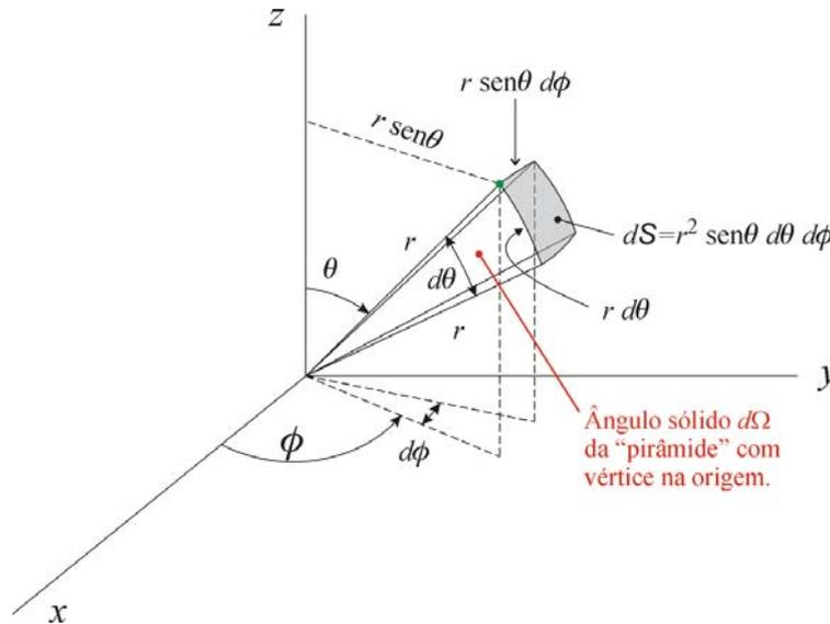
**Figura 9:** Área  $dS = r^2 \text{sen} \theta d\theta d\phi$  [m<sup>2</sup>] da superfície subentendida pelo ângulo sólido  $d\Omega = \text{sen} \theta d\theta d\phi$  [rad<sup>2</sup>].
