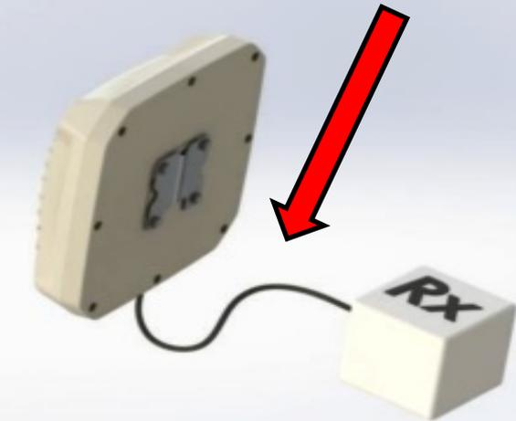
Impedâncias casadas nas interfaces antena RX-cabo e cabo-RX p/ máxima transferência de potência.
