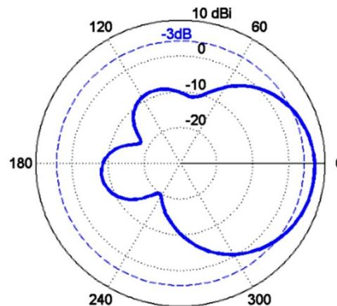
Padrão de radiação diretivo na antena TX p/ “focalizar” a irradiação da onda EM na antena RX e vice-versa.
