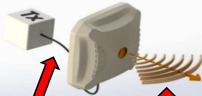
Impedâncias casadas nas interfaces TX-cabo e cabo-antena TX p/ máxima transferência de potência.
