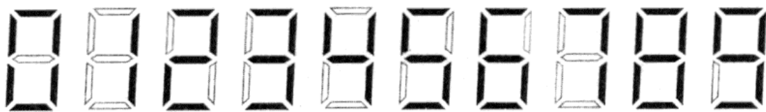
Figura 2: Algarismos decimais possíveis de serem formados mediante o acionamento combinado dos segmentos a, b, c, d, e, f, g .
