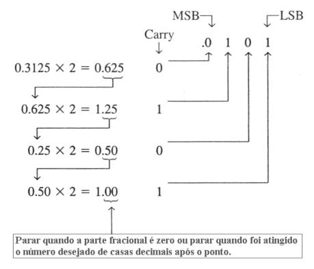
**Figura 2:** Conversão do número  $0.3125_{10}$  para seu equivalente em binário através do método Multiplicação por 2 Repetida.
