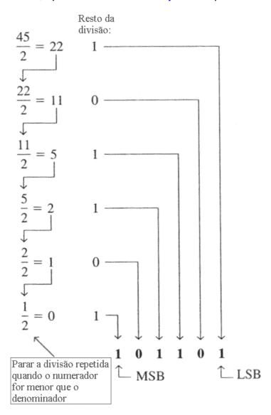
**Figura 1:** Conversão do número  $45_{10}$  para seu equivalente em binário através do método Divisão por 2 Repetida.
