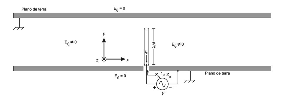
Monopolo aterrado parcialmente blindado eletromagneticamente por três planos de terra formando uma blindagem em "U":
