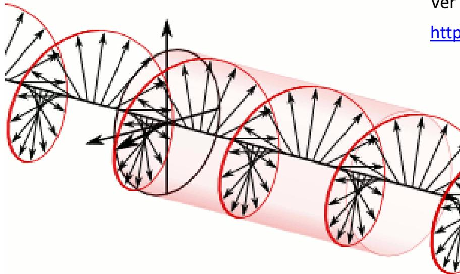
**Polarização circular esquerda (LHCP)** – vetor do campo  $\underline{E}$  gira no sentido anti-horário aos olhos do observador posicionado no eixo  $+z$  olhando para a origem do sistema cartesiano.
