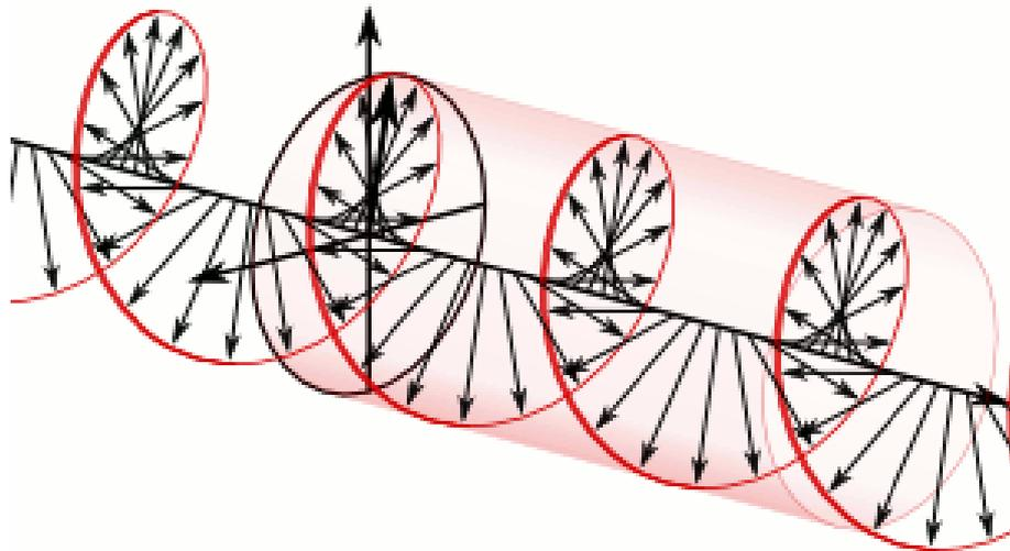
**Polarização circular direita (RHCP)** – vetor do campo  $\underline{E}$  gira no sentido horário aos olhos do observador posicionado no eixo  $+z$  olhando para a origem do sistema cartesiano.
