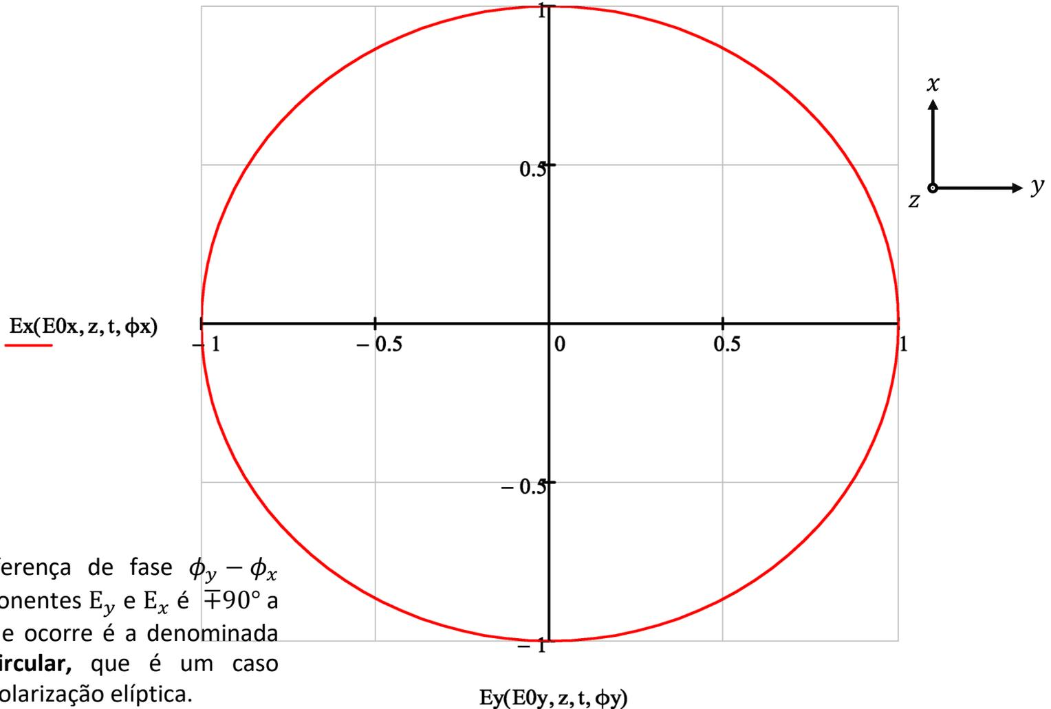
Quando a diferença de fase  $\phi_y - \phi_x$  entre as componentes  $E_y$  e  $E_x$  é  $\mp 90^\circ$  a polarização que ocorre é a denominada **polarização circular**, que é um caso particular da polarização elíptica.
