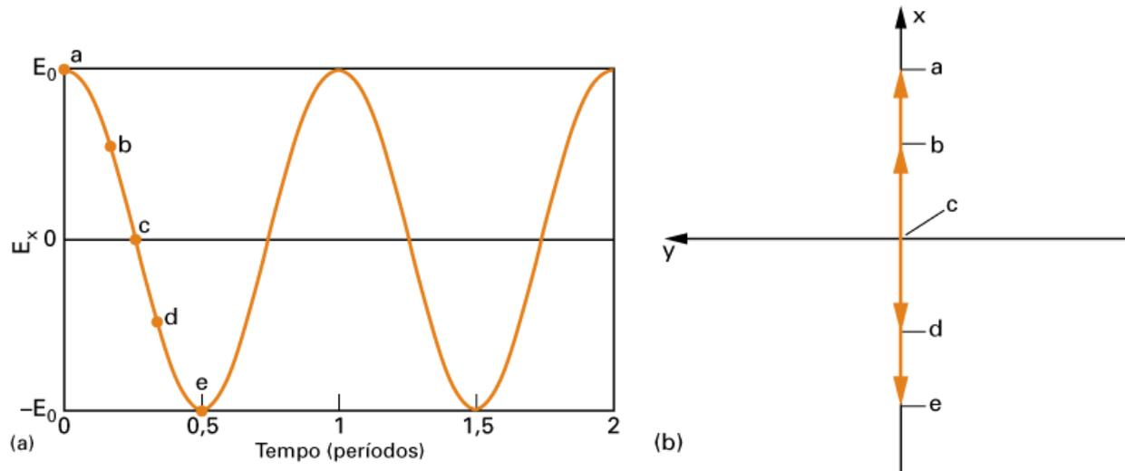
Em geral, qualquer onda plana uniforme pode ser constituída por um par de ondas polarizadas linearmente.
