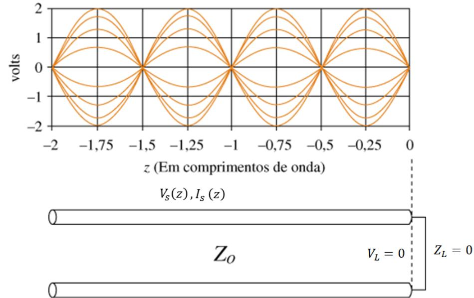
A impedância de entrada para um comprimento arbitrário  $l$  da linha terminada em curto é dada por
