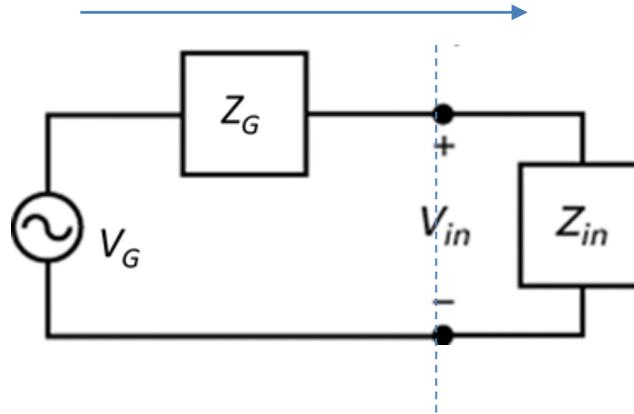
O gerador é considerado como uma LT, então a impedância de carga desta linha é  $Z_{in}$ , e a impedância característica desta linha é a impedância  $Z_G$  do gerador.
