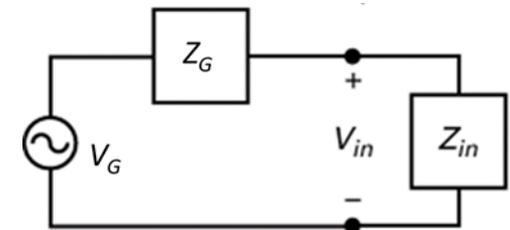
Note que estamos maximizando a transferência de potência na entrada da LT, mas como a LT é sem perdas, equivale a maximizar a transferência de potência à carga.
