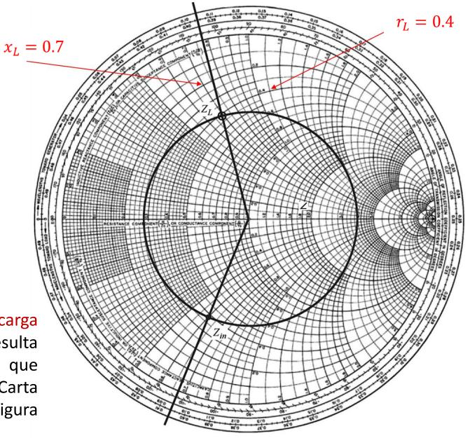
A impedância de carga normalizada por  $Z_0$  resulta em  $z_L=0.4+j0.7\Omega$ , que pode ser plotada na Carta de Smith conforme figura ao lado.
