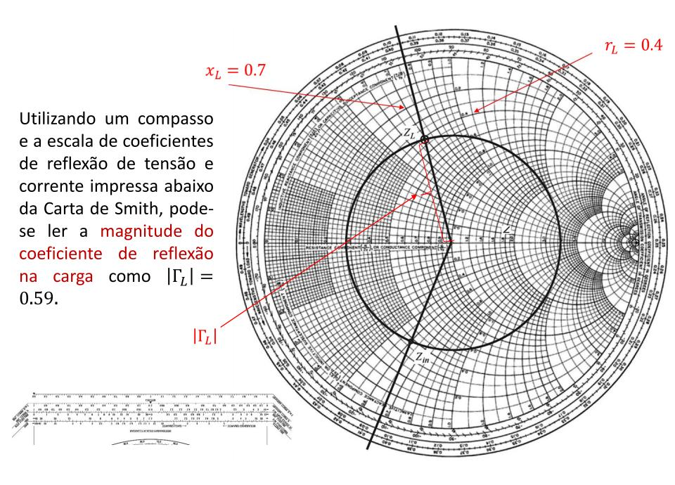
A mesma medida obtida com o compasso que foi usada para determinar a magnitude do coeficiente de reflexão na carga pode ser aplicada à escala de Relação de Onda Estacionária para obter ROE = 3.87 e à escala de Perda de Retorno, para determinar RL = 4.6dB.
