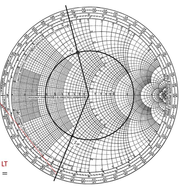
A magnitude do coeficiente de reflexão na entrada é a mesma  $(|\Gamma_{in}| = |\Gamma_L| = 0.59)$ , e a fase é lida a partir da linha radial na escala de fase, como -112°.
