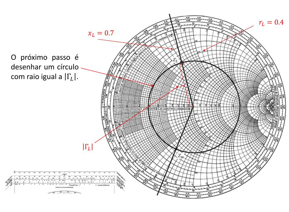
Desenhando uma linha radial que passe através do ponto de impedância de carga  $(z_L)$  até a escala externa do gráfico podese ler o ângulo do coeficiente de reflexão na carga  $(\Gamma_L)$ , como  $104^\circ$ .
