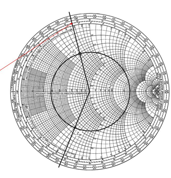
Estendendo esta linha radial até a escala de comprimento de onda em direção ao gerador (WTG, na Carta), obtém-se o valor de 0,106λ.
