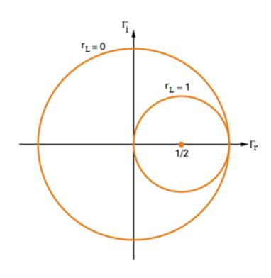
Equação geral para um círculo de raio a, centrado em x=m e y=n:
