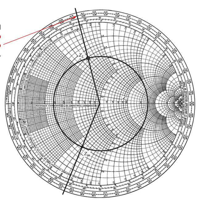
Deslocando a linha radial  $0.3\lambda$  (a dimensão da LT é 0.3  $\lambda$ ) em direção ao gerador, encontraremos  $0.406 \lambda$ na escala WTG.
