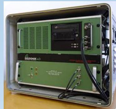
*Figura à esquerda: Ionossonda*
