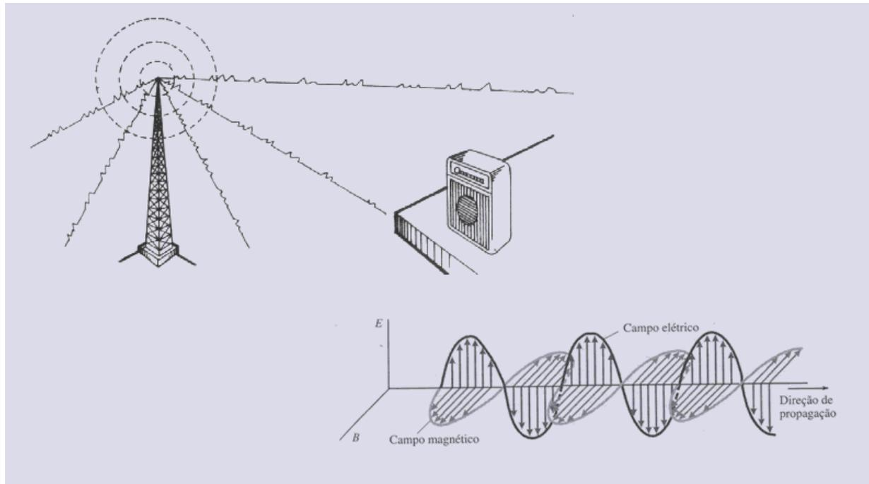
Esse fluxo de energia atravessa um meio na forma de um Campo Elétrico  $E$  e de um Campo Magnético  $H$ .
