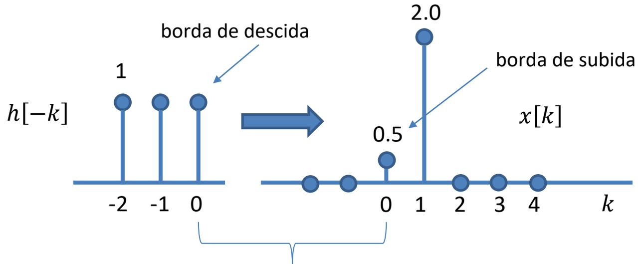
O primeiro produto não nulo ocorre quando a borda de descida de  $h[-k]$  se superpõe à borda de subida de  $x[k]$ . Neste exemplo, o deslocamento necessário para que as bordas se superponham é  $n = 0$ , portanto o que está sendo calculado é a amostra  $y[n = 0]$ .
