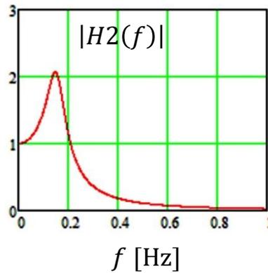
Note que embora as expressões para  $H1(\omega)$  e  $H2(\omega)$  tenham formas algébricas distintas, ela são numericamente equivalentes (porque os gráficos de magnitude e fase são idênticos). Portanto  $H1(\omega)$  e  $H2(\omega)$  são algebricamente equivalentes. Ou seja, a resposta em frequência de um sistema LTI pode ser obtida tanto a partir de sua equação diferencial como também a partir das operações diferenciais de seus elementos (indutor e capacitor, no caso).
