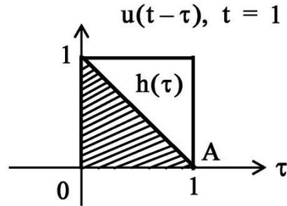
Usando a integral de convolução (31)  $y(t) = h(t) * u(t) = \int_{-\infty}^{\infty} u(t - \tau)h(\tau)d\tau$ , podemos especificamente determinar a área resultante (i.e., o resultado de  $h(t) * u(t)$ ) em função do deslocamento  $t$  no intervalo  $0 < t < 1$ :
