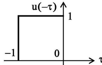
A seguir formamos  $u(t - \tau)$  deslocando  $u(-\tau)$  ao longo do eixo  $\tau$  de um deslocamento  $t$  à direita conforme mostra a figura abaixo:
