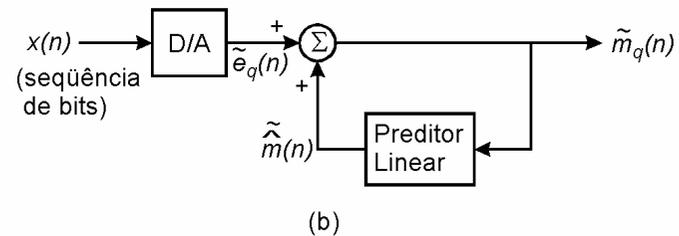
– No transmissor digital, a soma da previsão  $\hat{m}(n)$  com a versão quantizada  $e_q(n) = Q\{e(n)\}$  do erro de previsão  $e(n)$  resulta no sinal quantizado  $m_q(n) = \hat{m}(n) + e_q(n)$ .
