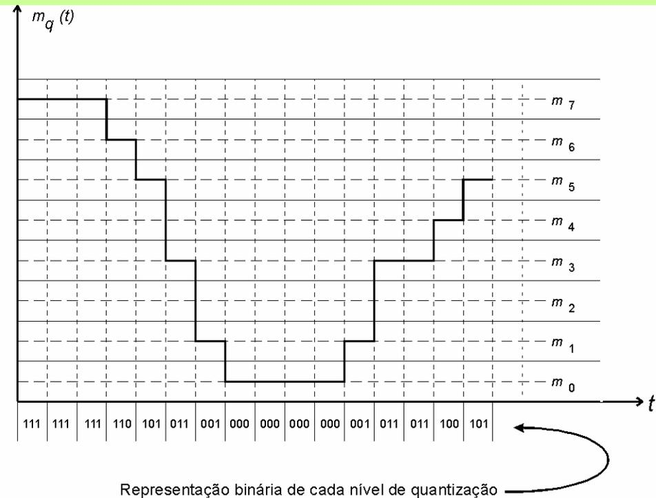
No processo ilustrado, utilizou-se uma representação de  $N = 3$  bits para cada um dos  $M = 8$  possíveis níveis (ou patamares) de quantização.
