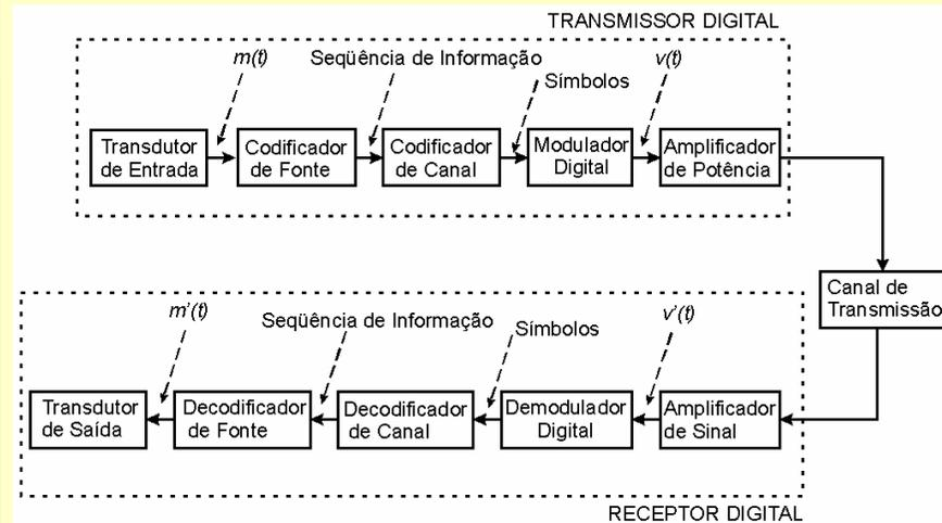
**3. Codificação:** Processo através do qual cada um dos  $M$  possíveis valores de  $m_q(n) \in \Theta$ ,  $\Theta = \{m_0, m_1, \dots, m_{M-1}\}$ , é mapeado em uma seqüência (ou bloco) de  $N = \log_2 M$  dígitos binários (ou bits). Cada um dos elementos do conjunto  $\Theta = \{m_0, m_1, \dots, m_{M-1}\}$  é associado a um  $n^\circ$  representado por  $N$  bits. O tipo de mapeamento a ser utilizado é dependente do código adotado.
