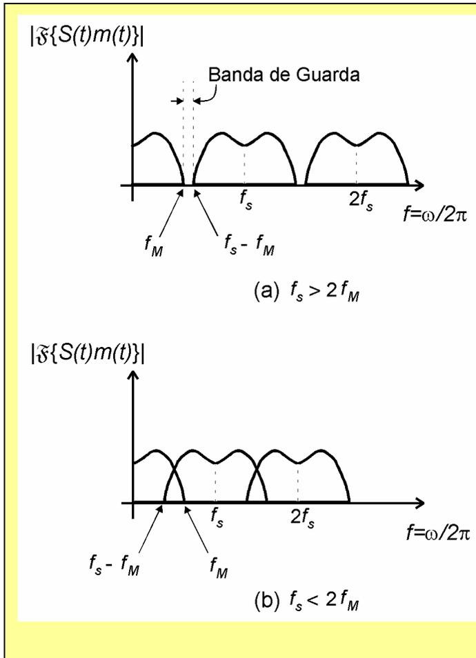
A Figura (a) mostra a banda de guarda que é obtida quando  $f_s > 2f_M$ .
