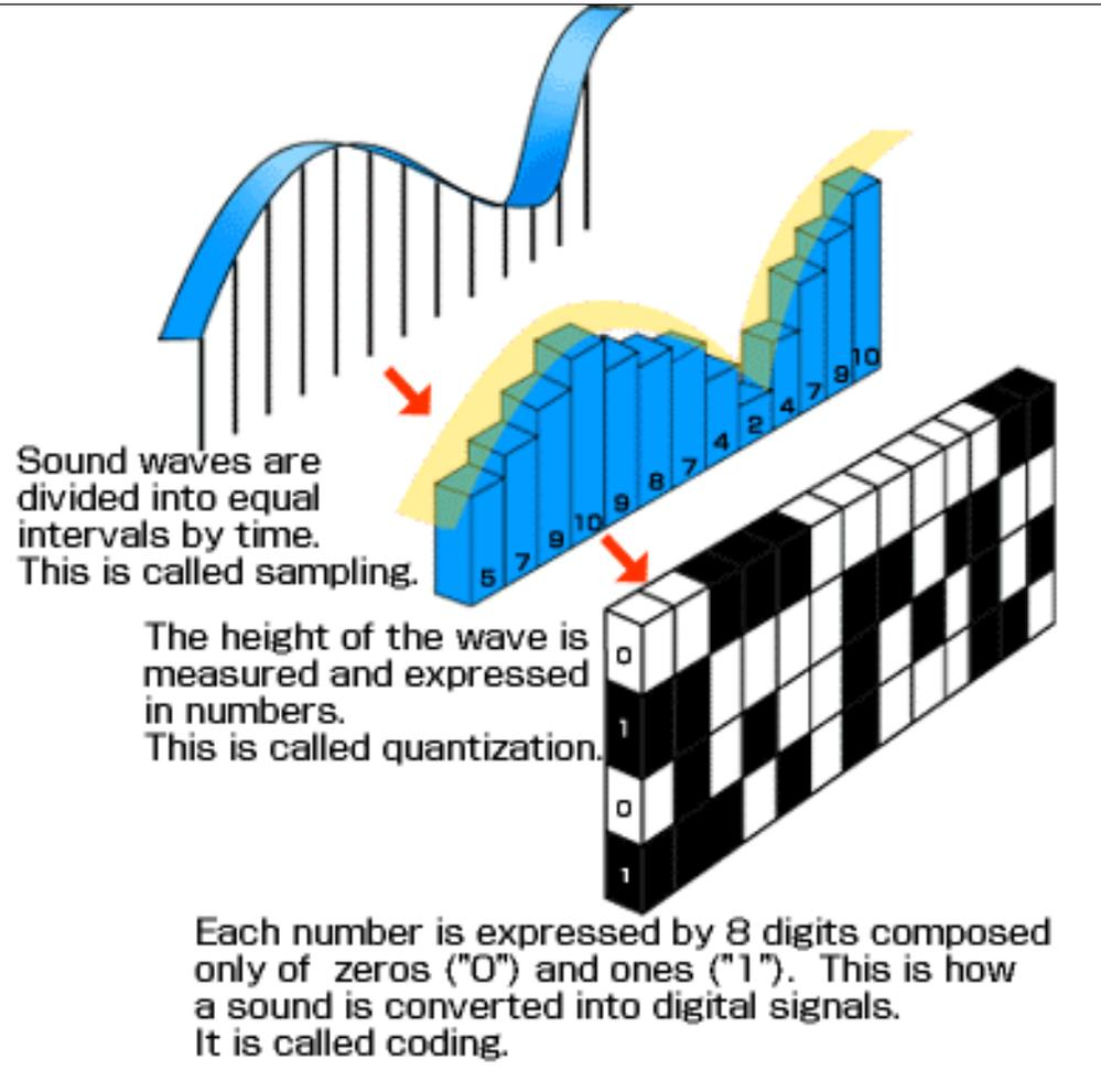
(exemplo.: sinal de voz  $f_M = 3.3k\text{ Hz}$ ,  $f_s = 8.0k\text{ Hz}$ )
